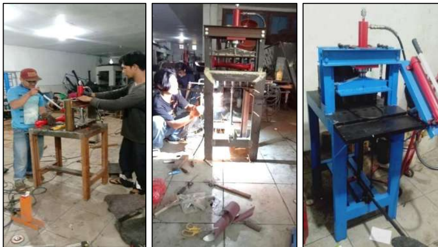
Gambar 4. Proses Pembuatan Alat Pres Pencetak Arang Briket
