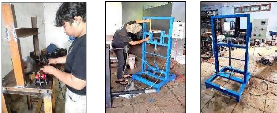
Gambar 7. Proses Pembuatan Hot Moulding Press
