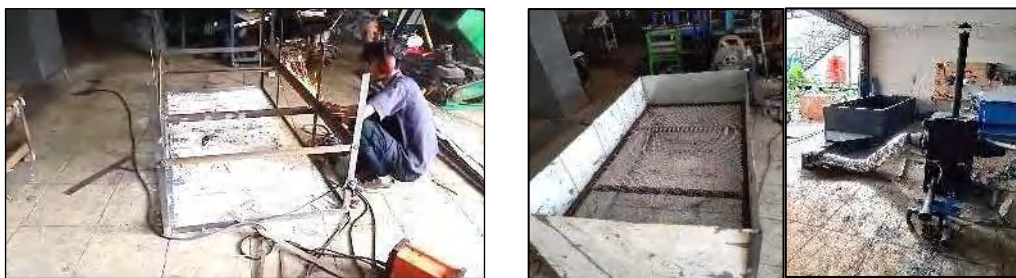
Gambar 6. Proses Pembuatan Flatbed Dryer
